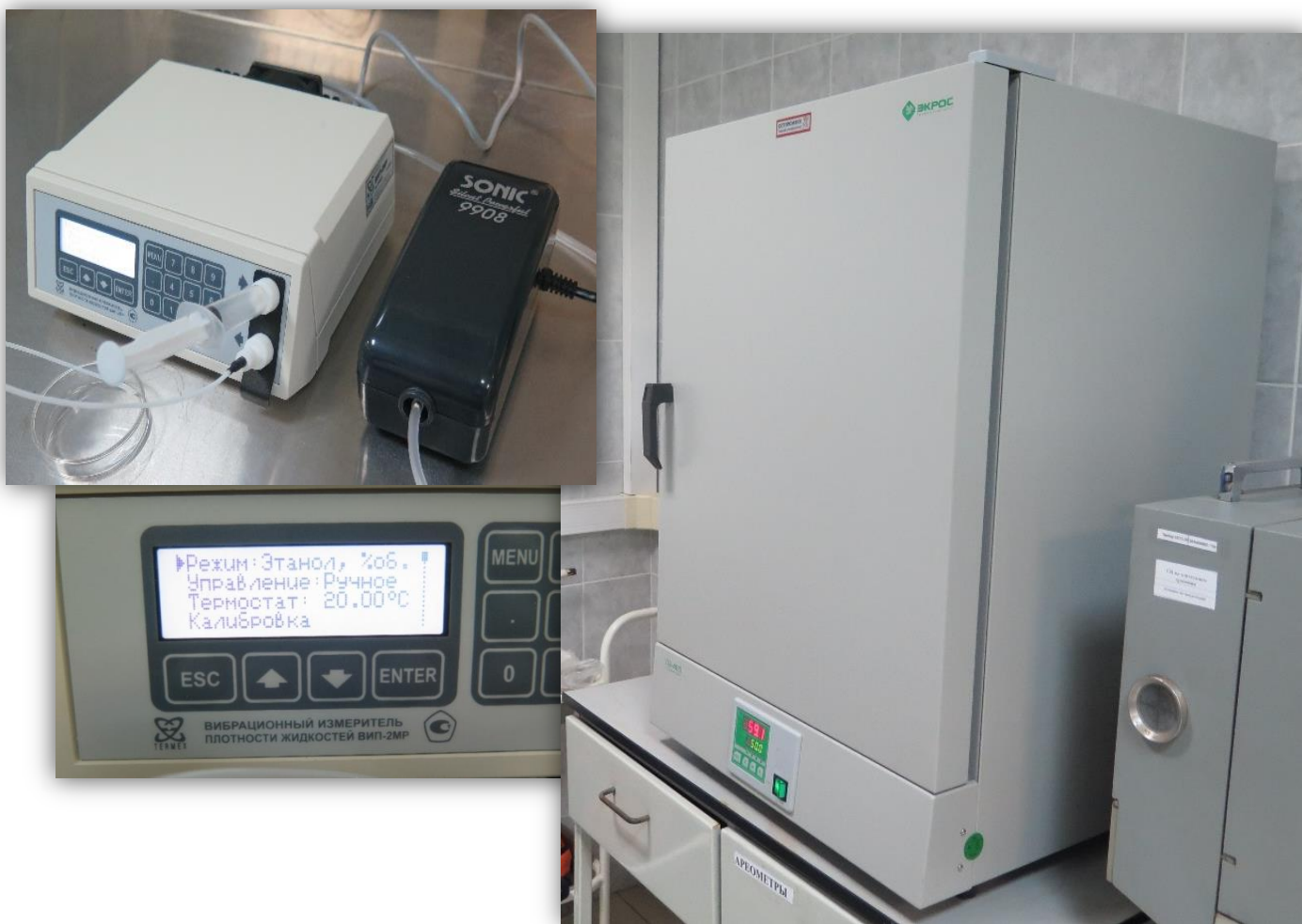
Портативный лабораторный плотномер вибрационный ВИП-2МР «Термекс» и сушильный шкаф ПЭ-4610 «Экрос»
